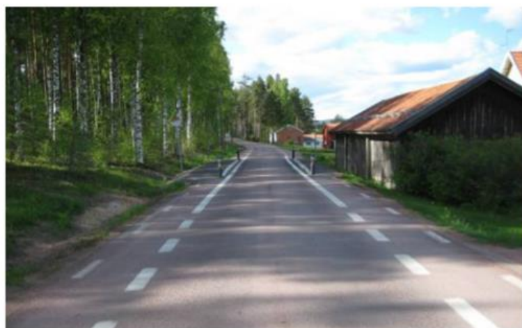
Figur 49 Avsmalning vid en busshållplats (de gamla vägrensmarkeringarna finns kvar)
